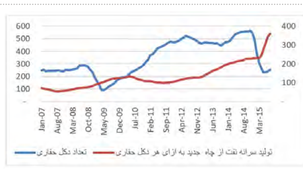
شکل ۱۲ | تعداد دکل‌ها (نمودار سمت چپ) و تولید سرانه نفت از چاه جدید (نمودار سمت راست) - حوزه پرمین. مأخذ: EIA (2015).
