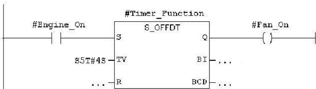
□ تابع Timer \_ Function # با پارامتر ورودی Engine \_ On # استارت می گردد.
