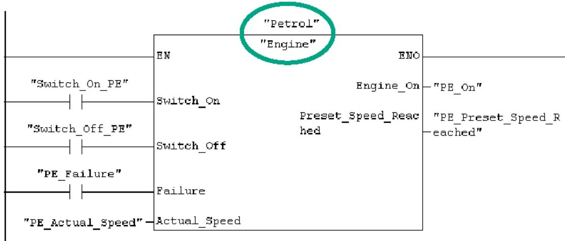
□ متغیرهای ورودی - خروجی مشخصه موتور (که بصورت **In** و **Out** نمایش داده می شوند) در بلوک تابعی **Engine** نمایش داده می شوند.
