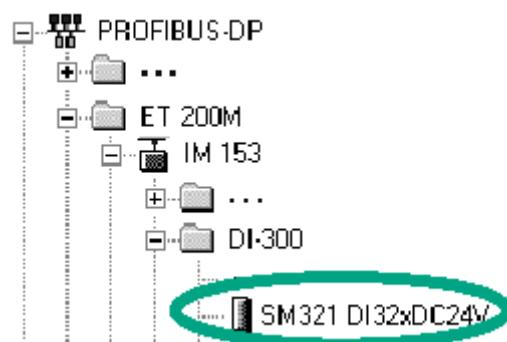
هنگام استفاده از کاتالوگ سخت افزاری همواره از بودن در پوشه مورد نظرتان اطمینان حاصل نمایید. مثلًا برای انتخاب کارت جهت **ET 200M** باید بداخل **ET 200M** رجوع نمایید.
