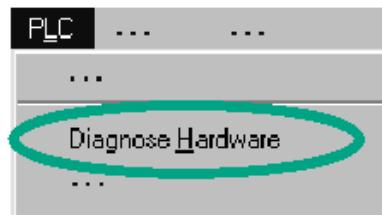
کلیه CPU های قابل دسترسی در کادر مکالمه Diagnosing Hardware لیست شده اند. CPU ای که در حالت Stop قرار دارد (تصویرت رنگی) مشخص شده است. پروژه Module تنها همان یک CPU ای را که دارا است نمایش میدهد. بر روی Getting started کلیک نموده تا بافر خطای این CPU را ملاحظه نمایید.
