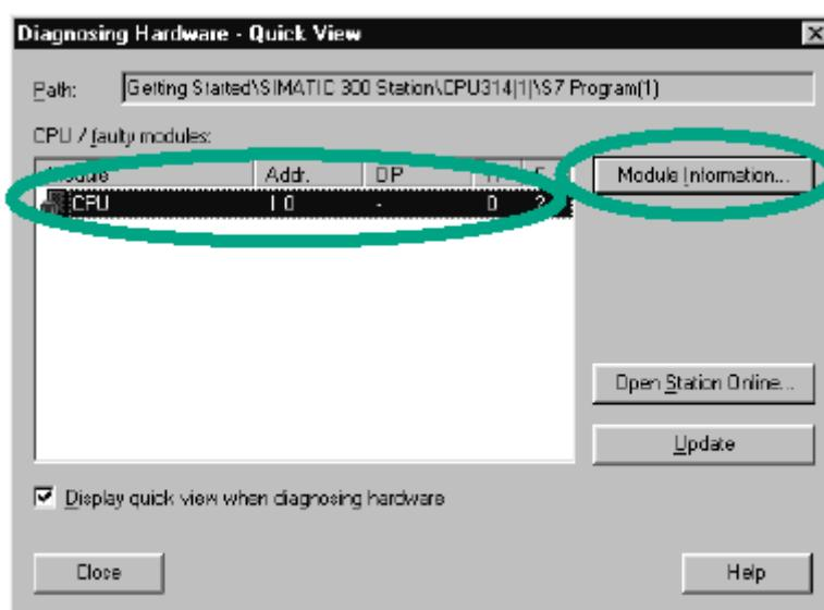
اگر تنها یک CPU در اختیار داشته باشد، می توانید برای دسترسی اطلاعات این CPU مستقیماً از دستور PLC > Module Information استفاده نمایید.
