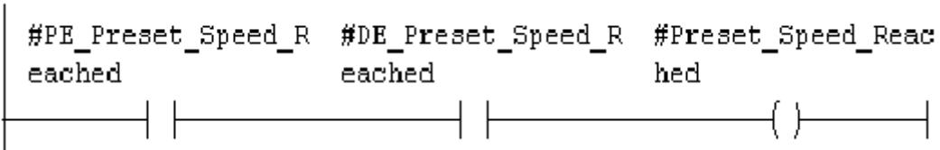
متغیرهای موقتی "DE-Setpoint-Reached" و "PE-Setpoint-Reached" به پارامتر خروجی "Setpoint" که بعداً در داخل OB1 مورد پردازش قرارمی گیرد اعمال می شوند.
