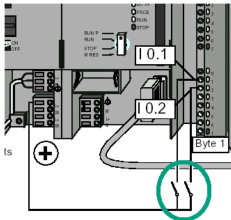
دیودهای ورودی I0.1 و I0.2 بر روی کارت ورودی روشن می‌شوند.
