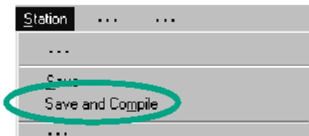
▣ فرمان **Save and Complile Consistency** مورد بررسی قرار می گیرد. اگر خطایی وجود نداشته باشد ، اطلاعات سیستمی ایجاد شده و می تواند به PLC منتقل شود. با استفاده از **Save** شما می توانید پیکربندی تان راحتی در صورت وجود خطا ذخیره نمایید. اما در مرحله بعد شما قادر به انتقال **(Download)** پیکربندی تان به PLC نخواهید بود.
