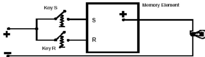
اگر کلید S فشار داده شود چراغ روشن شده و تا زمانیکه کلید R فشار داده شود روشن می ماند.
