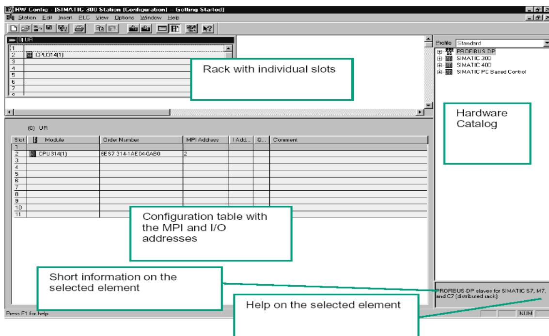
اولین چیزی که مورد نیازتان میباشد یک کارت منبع تغذیه میباشد. در داخل کاتالوگ آنقدر پیش بروید تا به **PS307 2A** برسید و آنرا برداشته و در داخل شیار 1 رها نمایید
