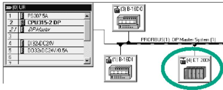
خود **ET 200 M** می تواند کارتهای ورودی / خروجی دیگری نیز داشته باشد. کارت **DI32×DC24V** را بعنوان نمونه برای شیار 4 انتخاب کرده و دوبار بر روی آن کلیک نموده تا وارد شود.
