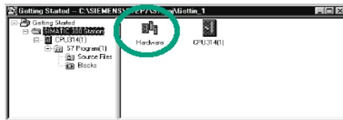
پوشه SIMATIC 300 Station را باز نموده و بر روی سymbol Hardware دوبار کلیک نمایید. پنجره "HW Config" باز می شود. CPU ای که هنگام ایجاد پروژه انتخاب نموده بودید نمایش داده می شود که برای پروژه "CPU 314" "Getting Started" میباشد.
