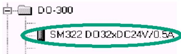
در صورتی که قصد داشته باشید پارامترهای (عنوان مثال ، آدرس ) یک کارت را درون پروژه ای تغییر دهید بر روی کارت مذکور دوبار کلیک نمایید. هرچند توجه داشته باشید که فقط در صورتیکه از نتایج حاصله از تغییراتی که میدهید بر روی PLC اطلاع دقیق دارید مبادرت به تغییر پارامترها ورزید.
