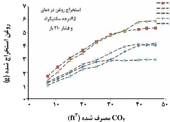
شکل ۲- استخراج روغن به وسیله CO<sub>2</sub> فوق بحرانی از ۱۹/۸ گرم روغن کارکرده در دمای ۴۵ درجه سانتیگراد و فشار ۲۱۰ بار.
