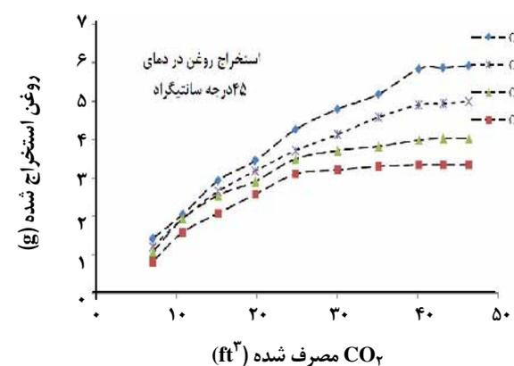
شکل ۴- استخراج روغن به وسیله  $\text{CO}_2$  فوق بحرانی از ۱۹/۸ گرم روغن کارکرده در دمای ۴۵ درجه سانتیگراد و فشارهای گوناگون.
