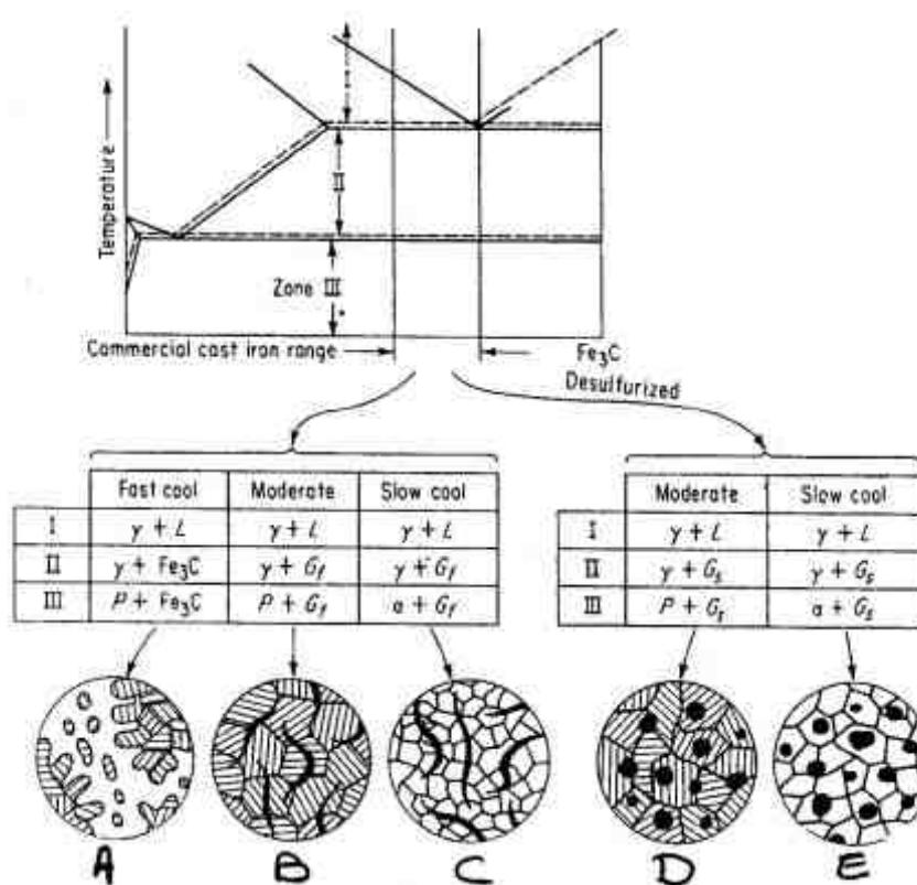
(۱) A - چدن سفید ، B - چدن خاکستری فربستی ، C - چدن خاکستری پرلیتی ، D - چدن پرلیتی داکتیل ، E - چدن فربستی داکتیل
